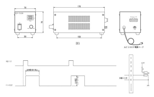
ストロポ点灯により、LEDの特性を最大限に引き出すことができます。デューティ10%以内にするように、トリガ周期と点灯時間を設定すれば、LED照明器の明るさは連続点灯時の4-5倍に得られます。
